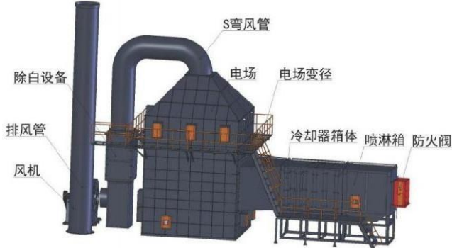
6.2-2 “水喷淋+间接冷却+静电”设备示意图
