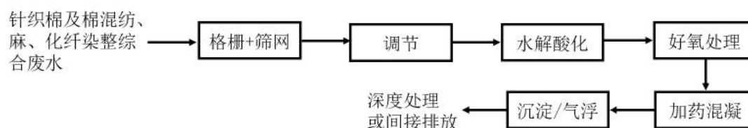
图 6.2-12 针织棉及棉混纺等染整的综合废水常规处理工艺流程图
